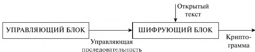
Рис. 2.8. Принципиальная криптохема поточного шифратора
