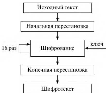
Рис. 2.10. Обобщенная схема шифрования в алгоритме DES
