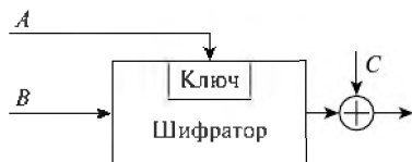
Рис. 6.3. Обобщенная схема формирования хэш-функции
