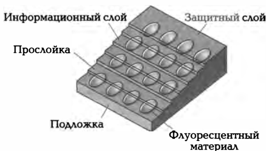
Рис. 3.13. FM-диск в разрезе
