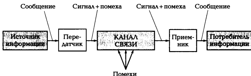
Рис. 8.1. Обобщенная структурная схема телекоммуникационной системы передачи информации
