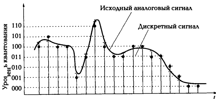
Рис. 5.3. Дискретизация по времени и квантование по уровню аналогового сигнала
