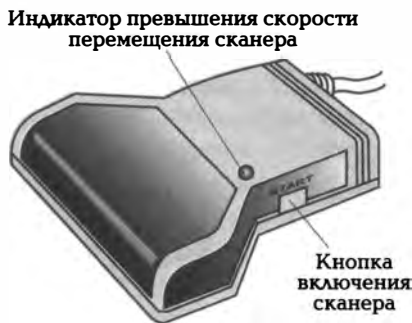
Рис. 6.9. Устройство ручного сканера
